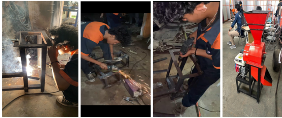
Gambar 2. Proses Pembuatan Mesin Penepung Kotoran Ternak
