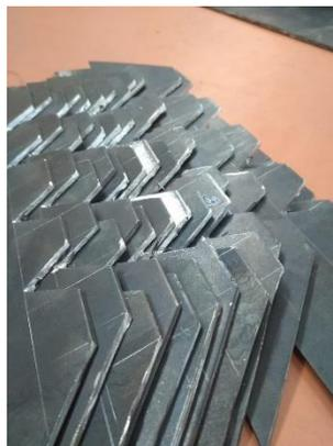
Gambar 4. Pembuatan Kuku Roda
