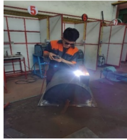
Gambar 21. Proses Pembentukan dan pengelasan Bodi Input
