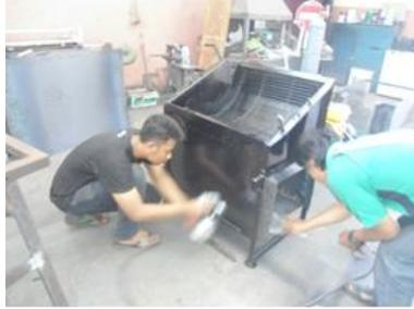
Gambar 10. Pengecatan Rangka
