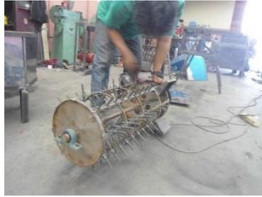
Gambar 7. Roda Perontok Pada Mesin Perontok Sistem Lorong Hembus
