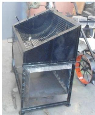
Gambar 9. Lorong Penghembus Pada Mesin Perontok
