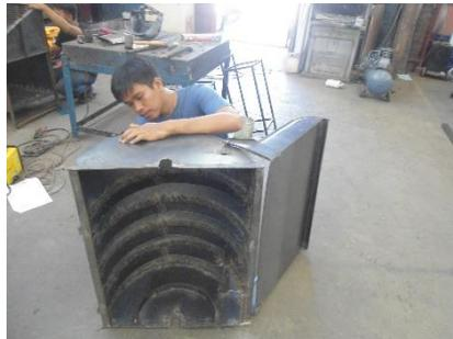
Gambar 8. Komponen Bagian Atas Perontok Sistem Lorong Hembus
