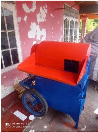
Gambar 11. Pengecatan Komponen
